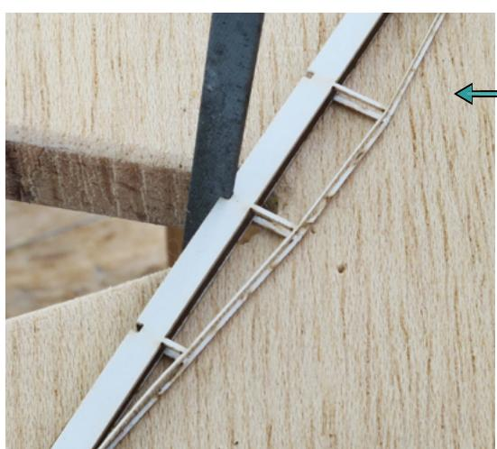
Après ces assemblages effectués, les échancrures doivent être élargies par limage. Vérifiez que **les pièces ci-dessous** s'y engagent bien, selon l'assemblage présenté à la page suivante
