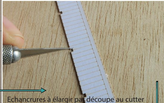
Echancreures à élargir par découpe au cutter ou X-acto, pour un bon encastrement à la base des montants de garde-corps.
